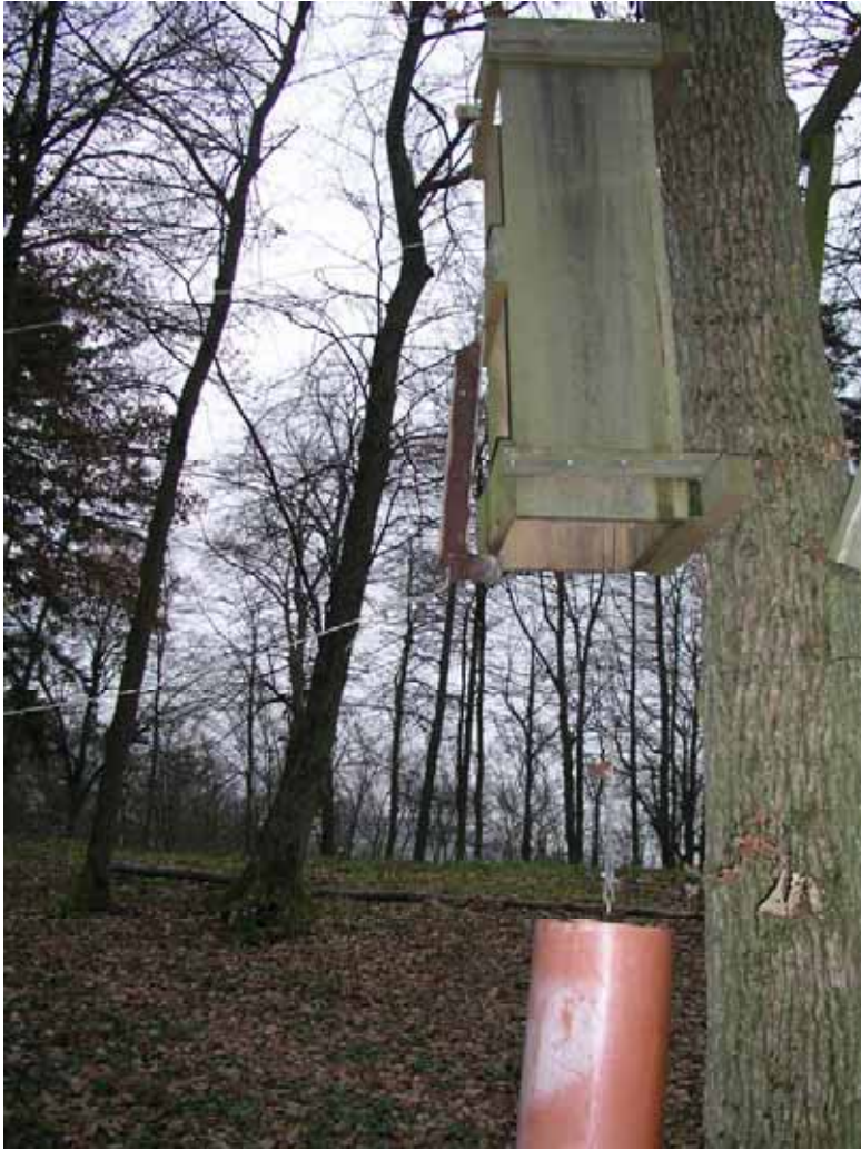
Bild 5: Auslöserhaken am Haltekasten für das Gegengewicht. Foto: Autor, 11/04
